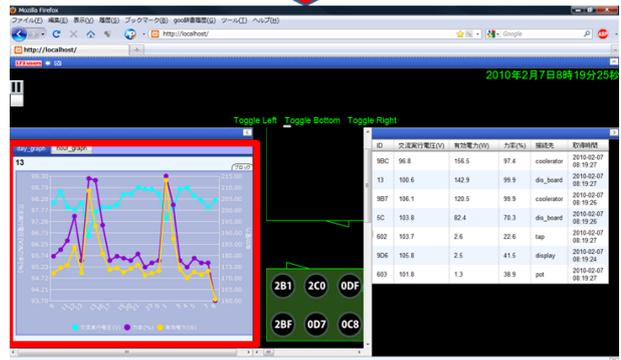
図 7 消費電力特性計測ノードのグラフ表示例
