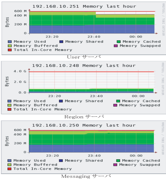
図 11 各サーバモジュールにおけるユーザログイン時のメモリ使用率
