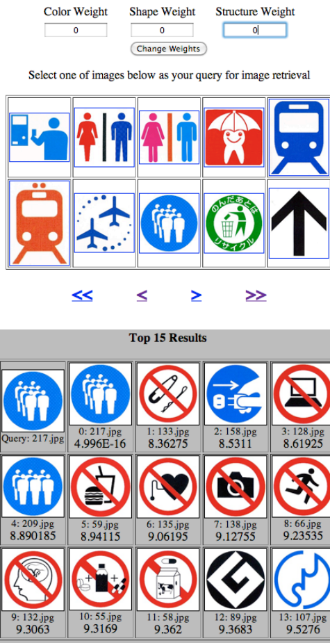
図 5 CBIR 機能の入出力インタフェースと結果表示例 (候補の表示)
