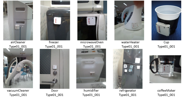
図 4 3 軸加速度センサと加速度センサを貼付した物体
