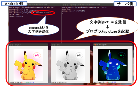
図 8 socket 通信を利用したアプリケーション起動例
