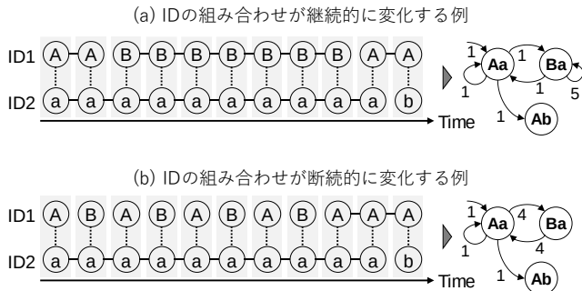
図 4 循環を有する遷移グラフの例
