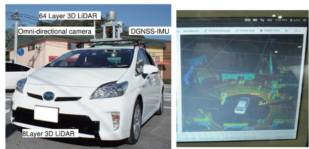
図1 移動ロボットの例 (センサを搭載した自動運転車)
