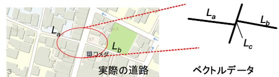
図 15 地図データ上で道路がずれている場合
