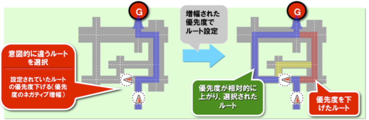
図 1 運転者の意図を用いた最適経路設定アルゴリズムの概要
