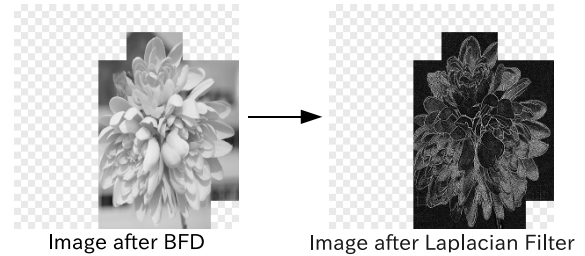
図 11 Laplacian Filter によるエッジ強度算出 Fig. 11 Edge Strength with Laplacian Filter
