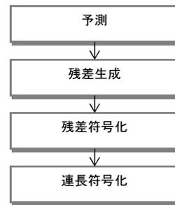
図4 時系列整数データ符号化方式の一般化
