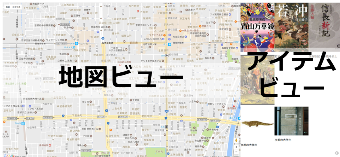
図 2 システムのインターフェース。地図ビューおよびアイテムビューから構成される。ユーザが地図ビューにおいて地図操作（移動，ズームイン，ズームアウト）を行うと，それに応じてアイテムビューに提示されるアイテムが動的に変化する。
