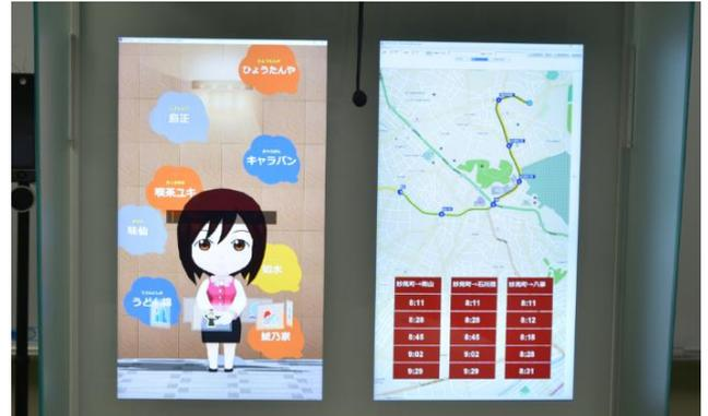
図7 MMDAgent とバス路線案内システムの連携動作。音声対話に応じてバス路線図と時刻表が動的に変化する。
