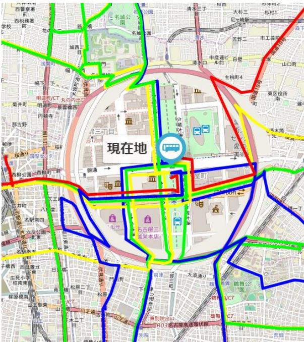
図3 Focus+Glue+Context マップ上にバス路線を描画する仕組みを実装。栄周辺を拡大表示すると同時に、栄を通る18の路線を重ねないようにずらして表示。
