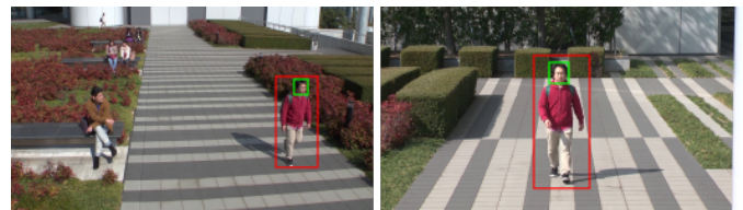
図 1 複数種類の特徴量を併用した複数カメラでの映像追跡。赤枠と緑枠はそれぞれ同一人物の全身と顔を囲んでいる。
