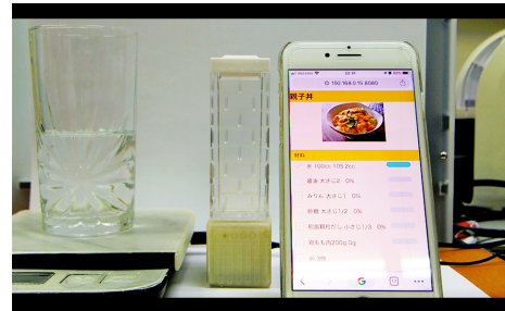
図 14 キッチンスケールとレシピの通信-プログレスバーが動く-
