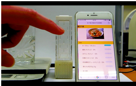
図 18 調味料ボックスとレシピの通信-調味料ボックスの LED が消灯-
