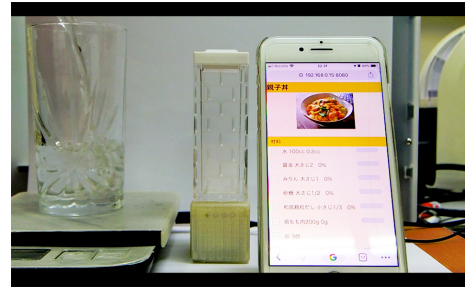
図 13 キッチンスケールとレシピの通信-水を加える前-
