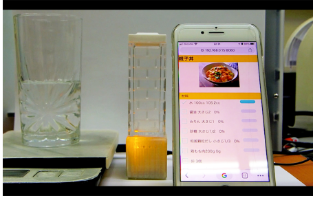
図 17 調味料ボックスとレシピの通信-調味料ボックスの LED が点灯-
