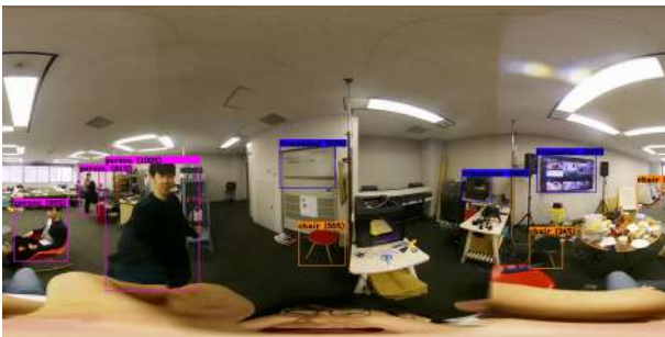
図 6 YOLOv3 による全天球パノラマ動画の物体検出結果
