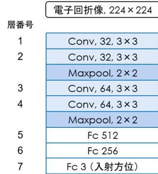
図 6 単結晶 TiO<sub>2</sub> の学習モデル
